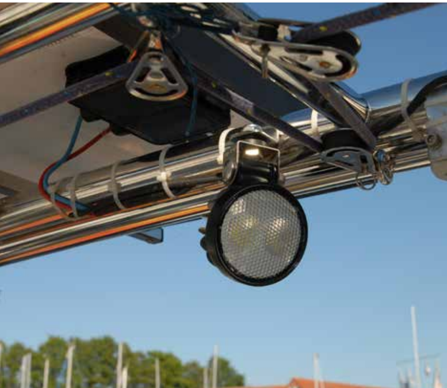
LED- Hecklicht und -Fahrlicht sollten immer fest am Träger montiert werden.
